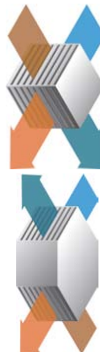
Kreuz-Gegenstrom-Wärmetauscher Rückwärmezahlen bis ca.98%.
